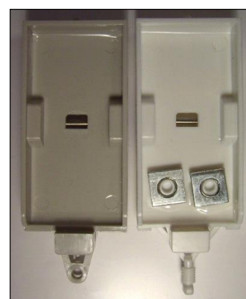
Boden/Fahrwerk links ohne, rechts mit Gewichten
