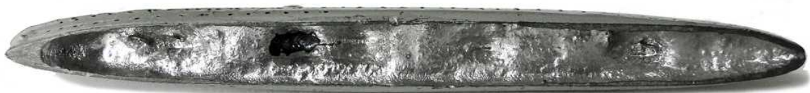
Schiefergussstruktur des Bodens
