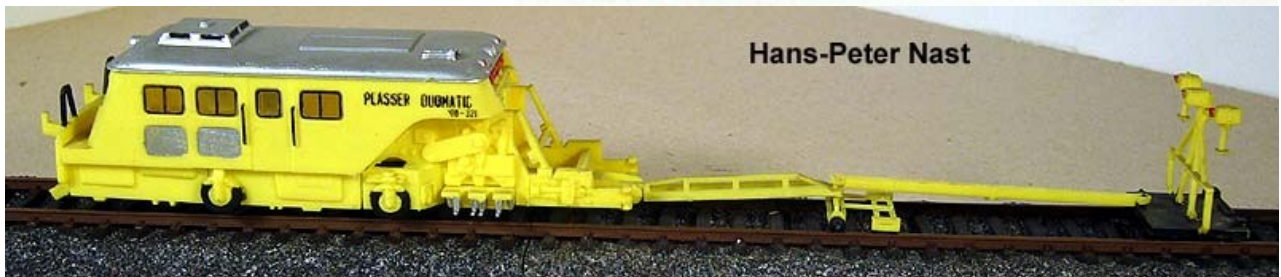
Gleisstopfmaschine mit ausgelegtem Strahlennivelliergerät (Foto: H.-P. Nast)
