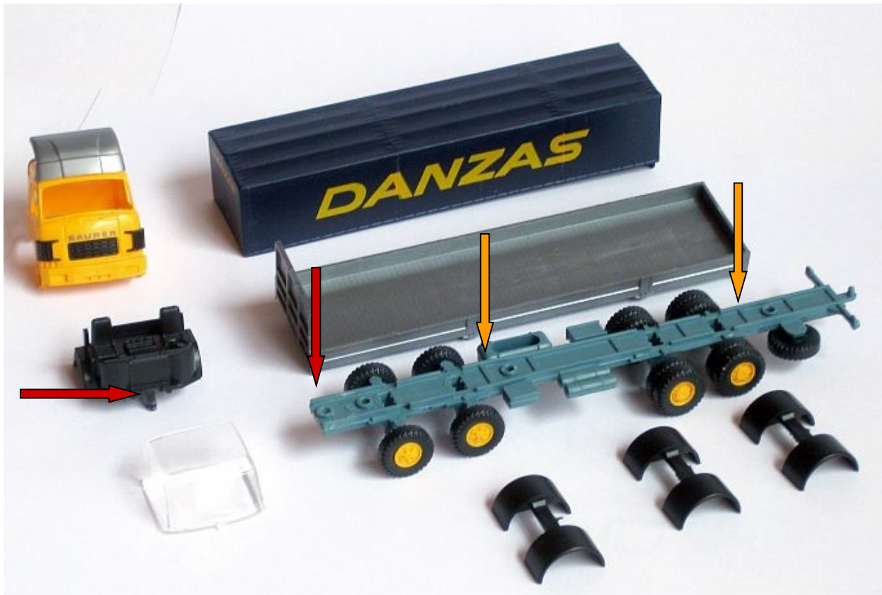
Zerlegtes Saurermodell. Bohrungen im Chassis zur Aufnahme der einzelnen Baugruppen.
